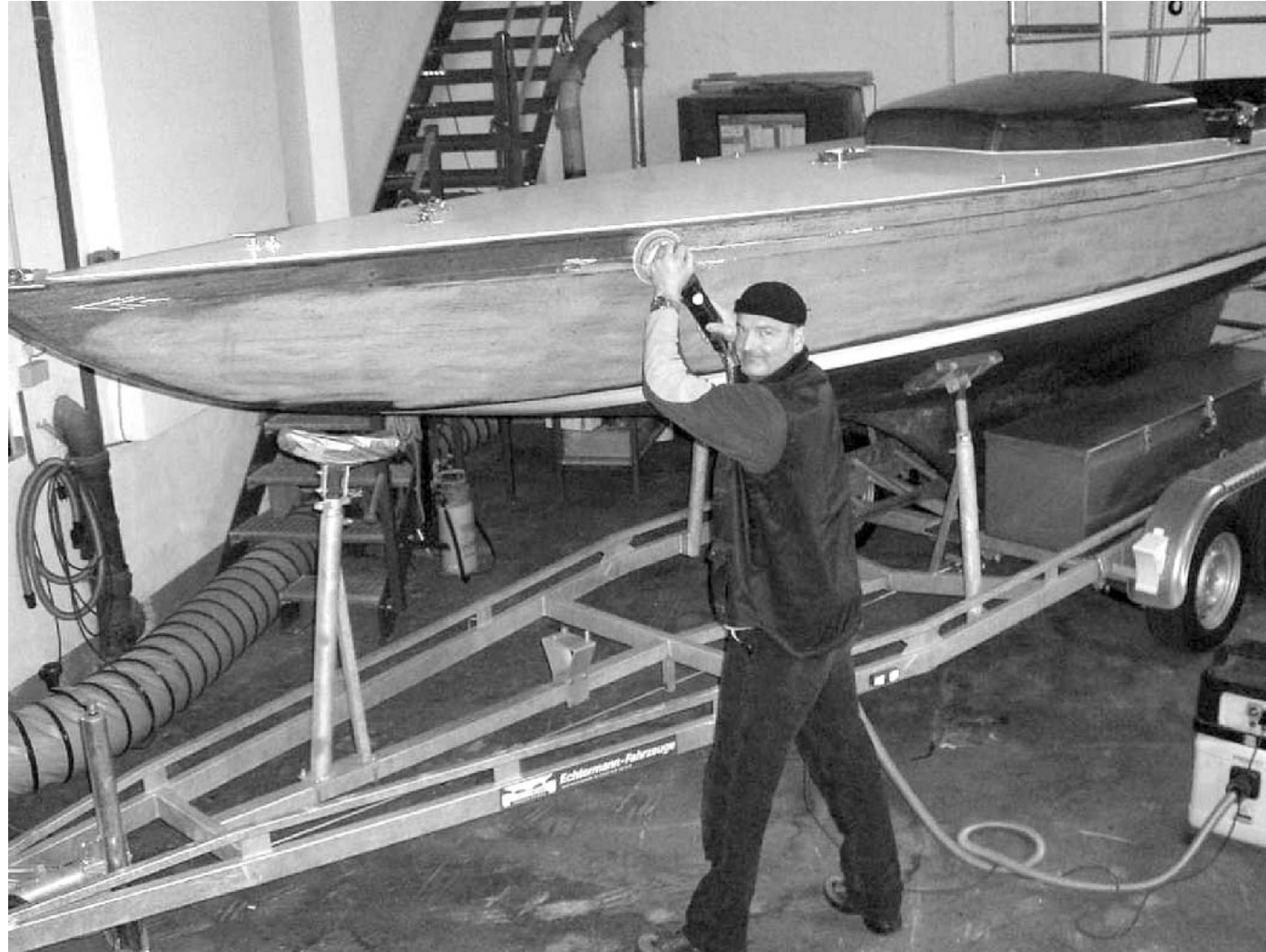
Bei der Arbeit: Mit einer sanften Polierscheibe sorgt Bootsbaumeister Dietmar Welling dafür, dass das schöne alte Holz des 1956 bei Abeking und Rasmussen gebaute Drachen wieder glänzt wie neu.
